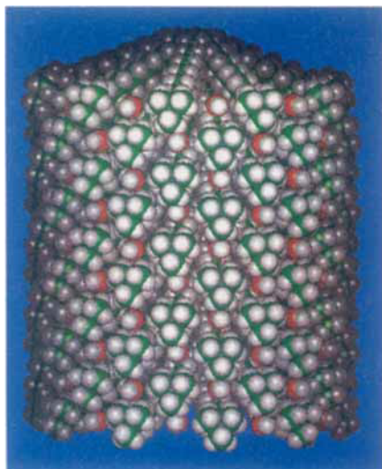
Abb. 2. Schematische Darstellung der äußeren Oberfläche einer zylindrischen Micelle. Die Enden des Micellenzylinders sind wahrscheinlich halbkugelig.
